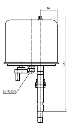
7.2. Габаритный чертеж – подсоединение
